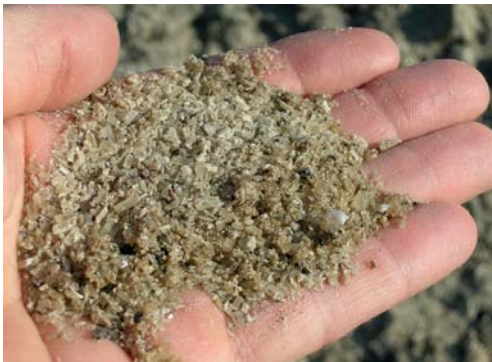
Bild 1 Aus Klärschlamm gewonnen: Magnesium-Ammonium-Phosphat-Dünger (MAP-Struvit)
