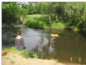
Abb. 2: Abflussmessung und Probenahme in der Ilmenau (Landkreis Uelzen)
